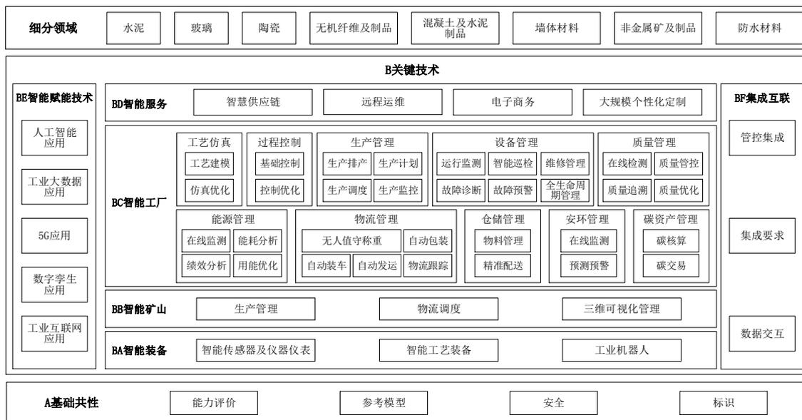
图 1 建材行业智能制造标准体系结构图
